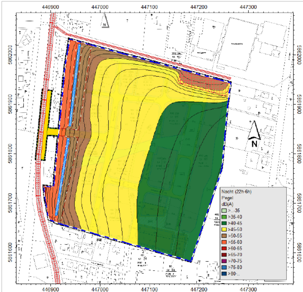
Abbildung 6: Beurteilung Verkehrslärm mit aktivem Schallschutz, nachts, OG, Quelle: I+B Akustik, ohne Maßstab
