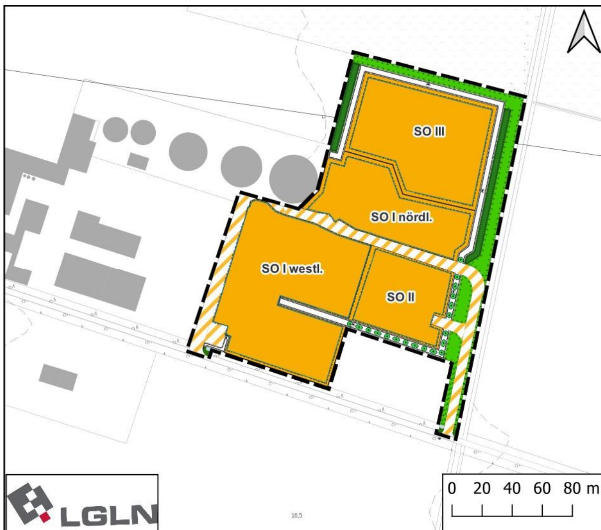
Abbildung 2: Darstellung der Festsetzungen im Geltungsbereich des VB-Plans „Biomethananlage Grüner Weg“ (schwarz gestrichelte Linie). M 1 : 2.500.
