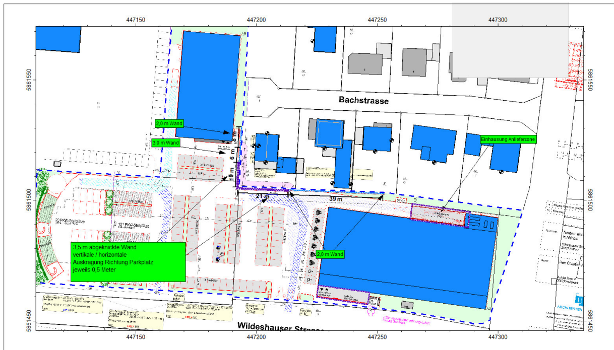
Abbildung 8: Kennzeichnung der erforderlichen aktiven Schallschutzmaßnahmen.
